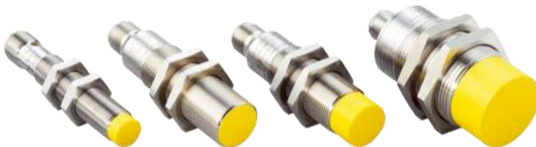
Индуктивные аварийные выключатели IN3000 Direct служат для определения положения. Компактная конструкция обеспечивает оптимальное размещение в оборудовании. Они работают бесконтактным методом, мало изнашиваются и не требуют специального ответного элемента, так как обнаруживают металлы. Благодаря большой области срабатывания они не зависят от допусков при установке и упрощают монтаж и юстировку. IN3000 Direct может подключаться через два выхода к системе управления безопасностью.
