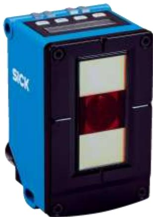
Оптические датчики контроля полосы распознают люминесцентные клейкие ленты для маркировки полос движения независимо от основания, загрязнения или дефектов и передают отклонения от центра полосы в систему управления. Полос просто и экономично прокладываются и изменяются. Кроме этого, во время движения датчики считывают 1D код и передают сведения о маршруте или команды на движение.
