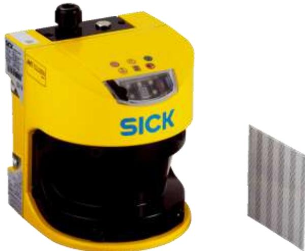
Переключение наборов полей постоянно обеспечивает контроль соответствующей длины поля в зависимости от скорости и положения движущегося транспортного средства.
